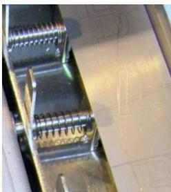
Den Schieber an der zu deponierenden Stelle nach hinten schieben und halten. Schlüssel am Schlüsselring von unten einführen, Schieber loslassen.
