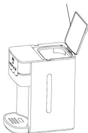
Tapa del depósito de agua
