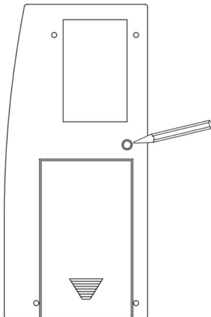
Um die Fernbedienung in den Anlernmodus zu bringen, drücken Sie mit einem spitzen Gegenstand auf die Anlern-taste. Danach befindet sich die Fernbedienung im Konfigurationsmodus, angezeigt durch grünes Blinken der Geräte-LED. (Wollen Sie den Konfigurationsmodus verlassen drücken Sie kurz nochmals die Anlern-taste.)
