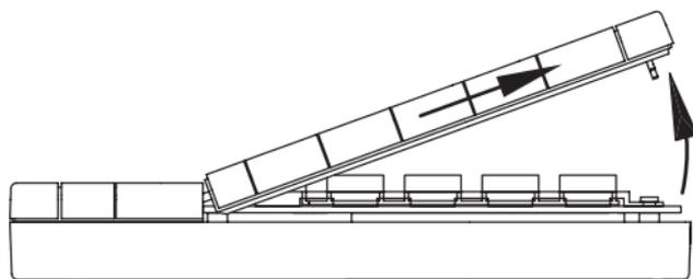
Legen Sie die Fernbedienung mit den Tasten nach oben vor sich auf den Tisch. Klappen Sie die Tastenabdeckung nach oben und ziehen Sie die Abdeckung schräg nach oben aus dem Gerät. Zwischen den Tastern ist nun die Leuchtplatte zugänglich. Hierauf
