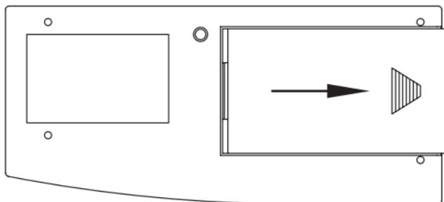
Öffnen Sie das rückseitige Batteriefach durch Schieben des Batteriefachdeckels in Pfeilrichtung. Legen Sie die mitgelieferten drei Micro Batterien (Typ LR 03) polrichtig entsprechend den Polaritätsmarkierungen in das Batteriefach ein.
