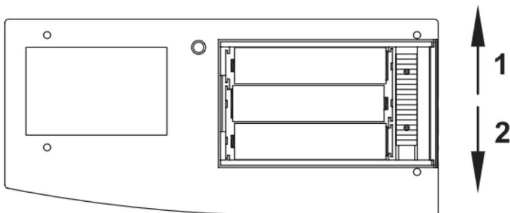
Öffnen Sie zunächst wie beim Batteriewechsel den Batteriefachdeckel. Unterhalb der Batterien befindet sich ein roter Schieber. Schieben sie den Schieber in Richtung 2.
