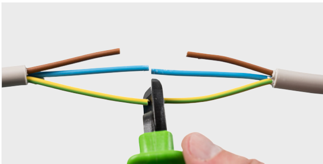
Kabel auftrennen, abmanteln und abisolieren.
