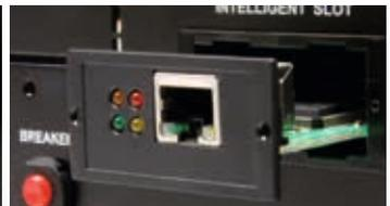
Die MTD ist serienmäßig mit einer RS-232 Einschubkarte versehen, welche durch optionale Adapter ersetzt werden kann: Relais-Karte, Optokoppler, USB oder SNMP.
